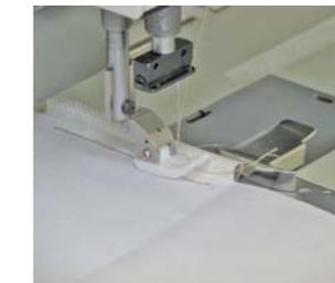
Aufnähen von Fahnenkeder mit Führung Magnetlineal, verstellbar.
