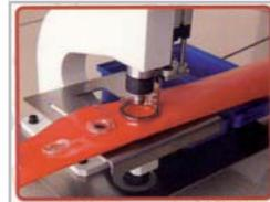
Pneum. Ösenstanze - nicht für textile Materialien stanzt und verbindet die Ösenteile in einem Arbeitsgang.
