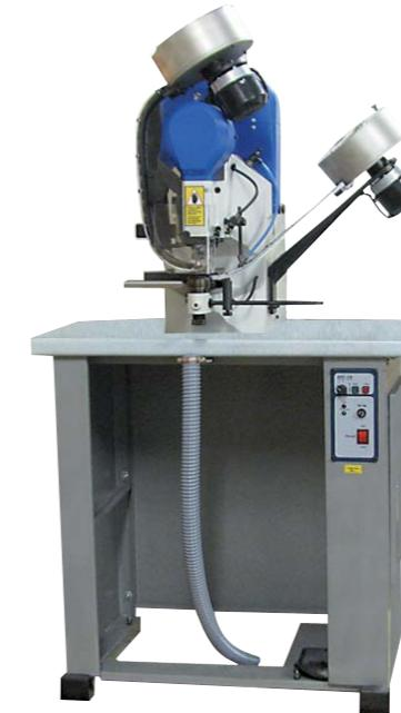
Autom. Zuführung von Ösen- Unter und Oberteilen. Das Ausstanzen der Löcher und das Verpressen der Ösen ist ein Arbeitsgang. Schnelles und sauberes Zuführen durch präzise Metallführung.
