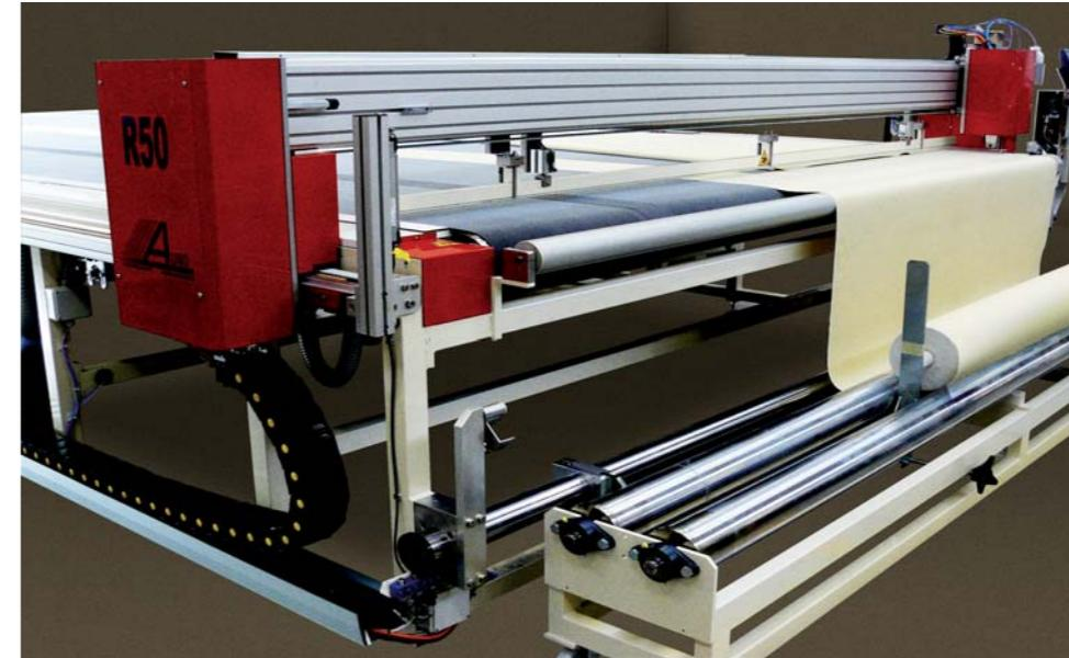
Diese Maschine schneidet auf dem Förderband ähnlich wie der CON-CUT - aber mit intelligentem XY - System mit einem Messerschneidkopf - sonst wie der Laser .
